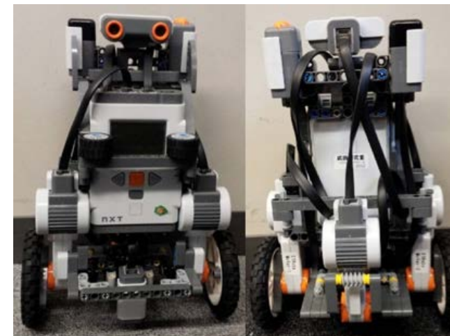
図4 ETロボコンで使用するロボット 左：前面 右：後面
