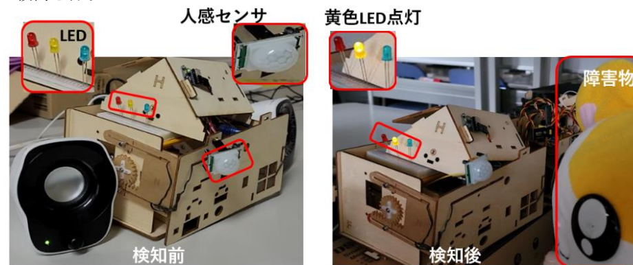
図 15 通常時の障害物検知機能実験
