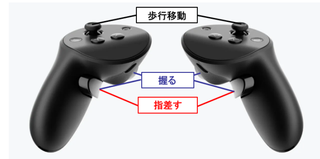
図 2 コントローラの操作方法 Fig.2 How to operate the controller
