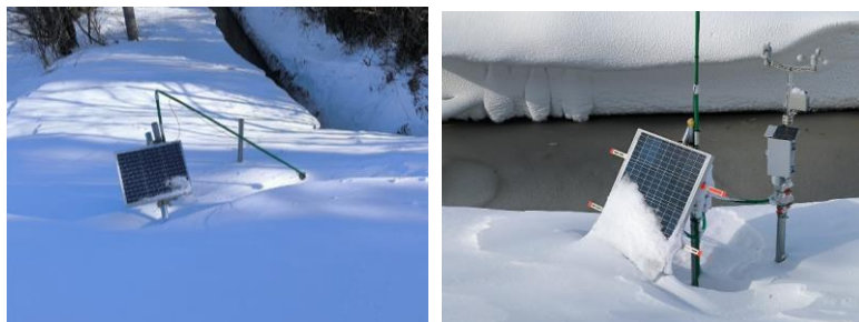
図 13 寒風沢地区の水位センサノード (左) と気象センサノード&ゲートウェイ (右)
