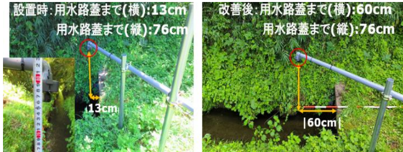
図 8 水位センサノードの超音波センサ位置変更前(左)と変更後(右)
