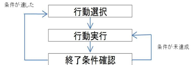
図2 制御プログラムの基本構造
